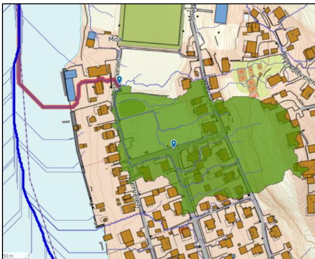
Bilde 7 Eksisterende avrenning til resipient, Scalgo Live.
